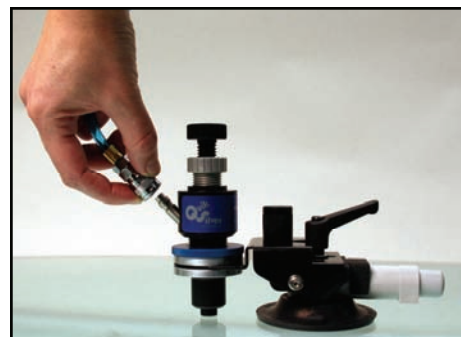
Collegamento del tubo all'attrezzatura per le riparazioni
