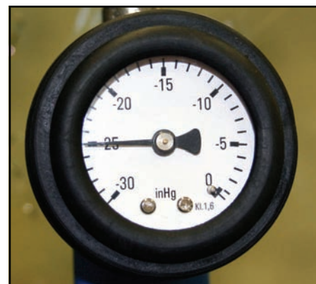
Calibro della pompa contenente 25 inHg di vuoto
