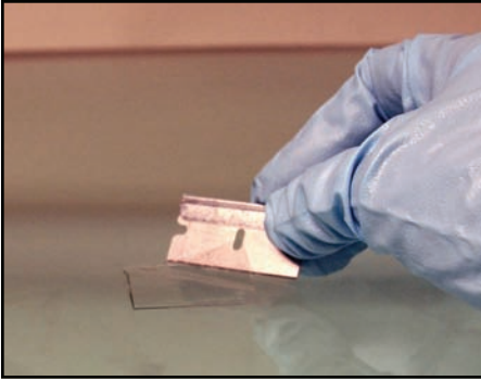
Sollevare il Mylar con una lama per rasoio
