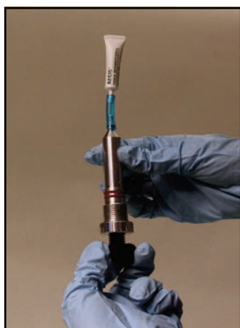
Aspirazione della resina nell'adattatore e nella camera di iniezione.
