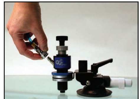
Conecte el Conjunto de la Manguera a la Pieza de Reparación
