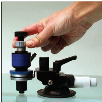
Giro de la Cámara de Inyección
