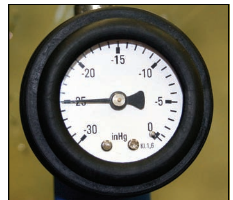
Manómetro de la Bomba con una Lectura de 25 inHg de Vacío
