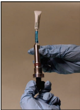
Introducción de resina en el adaptador y el inyector
