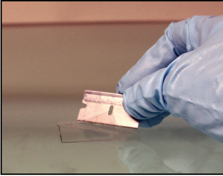
Soulever le Mylar à l'aide d'une lame de rasoir
