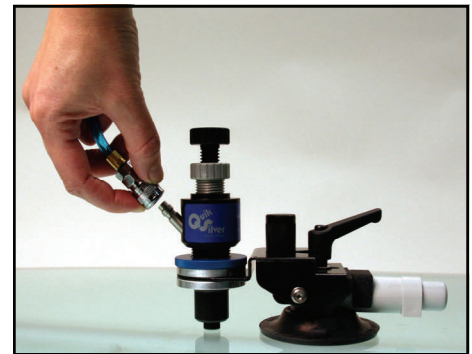
Attachez l'ensemble pour tuyau flexible à l'équipement de réparation
